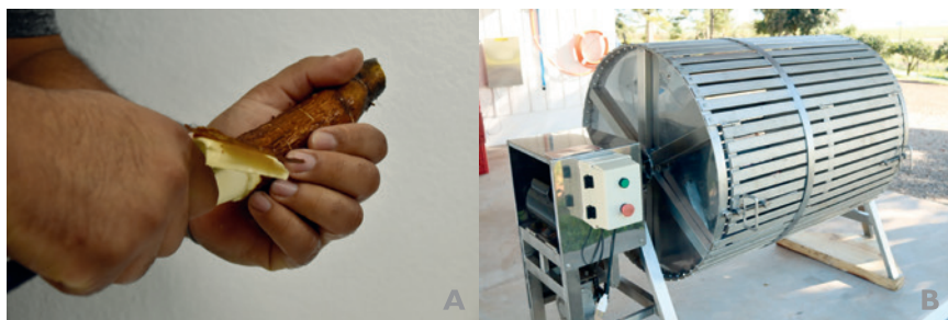
Figura 17 - (A) Descascamento manual das raízes de mandioca e (B) Lavador e descascador elétrico.
