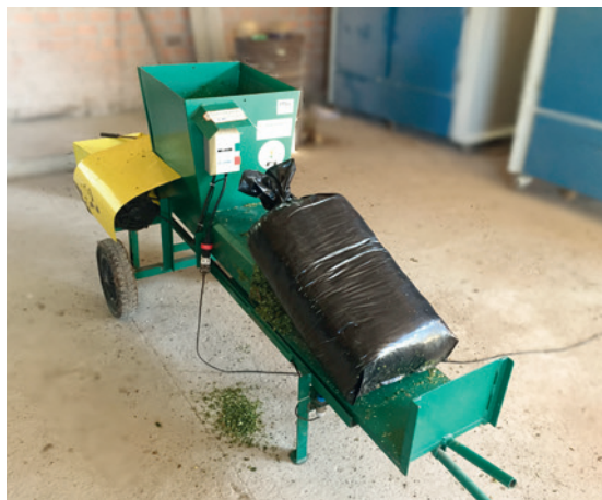
Figura 8 - Máquina ensacadora e compactadora de silagem.
