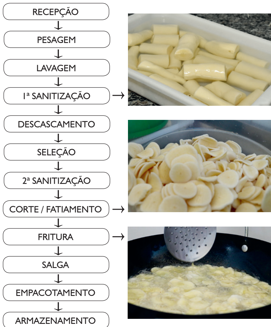
Figura 21 - Fluxograma de processamento da mandioca frita “chips”.
